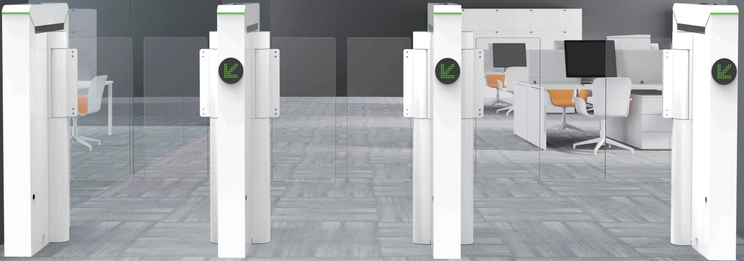
Mars-S100 시리즈는 SPCC 메탈 / 코팅 마감재로 제작된 ZKTeco의 컴팩트한 미니 플랩게이트입니다. 몸체 길이 600mm, 싱글, 듀얼 게이트 시리즈로 설계되었습니다. 넓은 900mm 레인(통로)확장으로 장애인용으로도 사용 가능하며, BLDC모터를 사용하여 소음이 적고, 내구성이 뛰어나며, 안전한 플랩게이트입니다. 게이트는 평상시 닫혀있으며, 승인되지 않은 방문객은 출입할 수 없게 제작 되었습니다.
